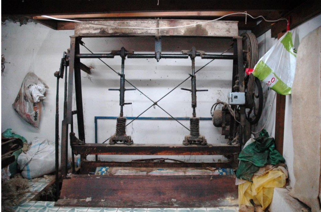
Fotograf 8: Rulo haline getirilen yünün tepilme işlemi
